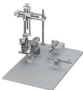
Cet instrument stéréotaxique portable/à rails pour rat utilise des blocs au lieu du cadre en U traditionnel, et offre aux chercheurs une aire opératoire spacieuse et ouverte.
